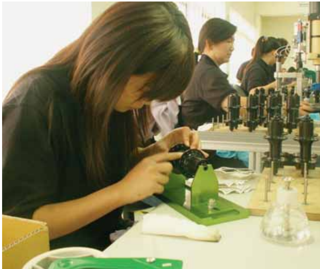
Montage von DT-Swiss-Naben durch Mitarbeiterinnen in Taiwan.
